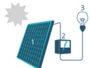
1. Zonnepaneel | 2. Omvormer | 3. Elektrische toestellen
