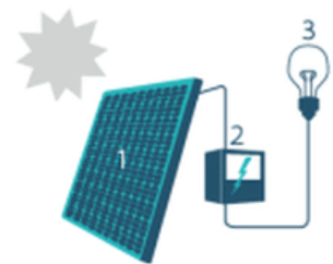
1. Zonnepaneel | 2. Omvormer | 3. Elektrische toestellen
